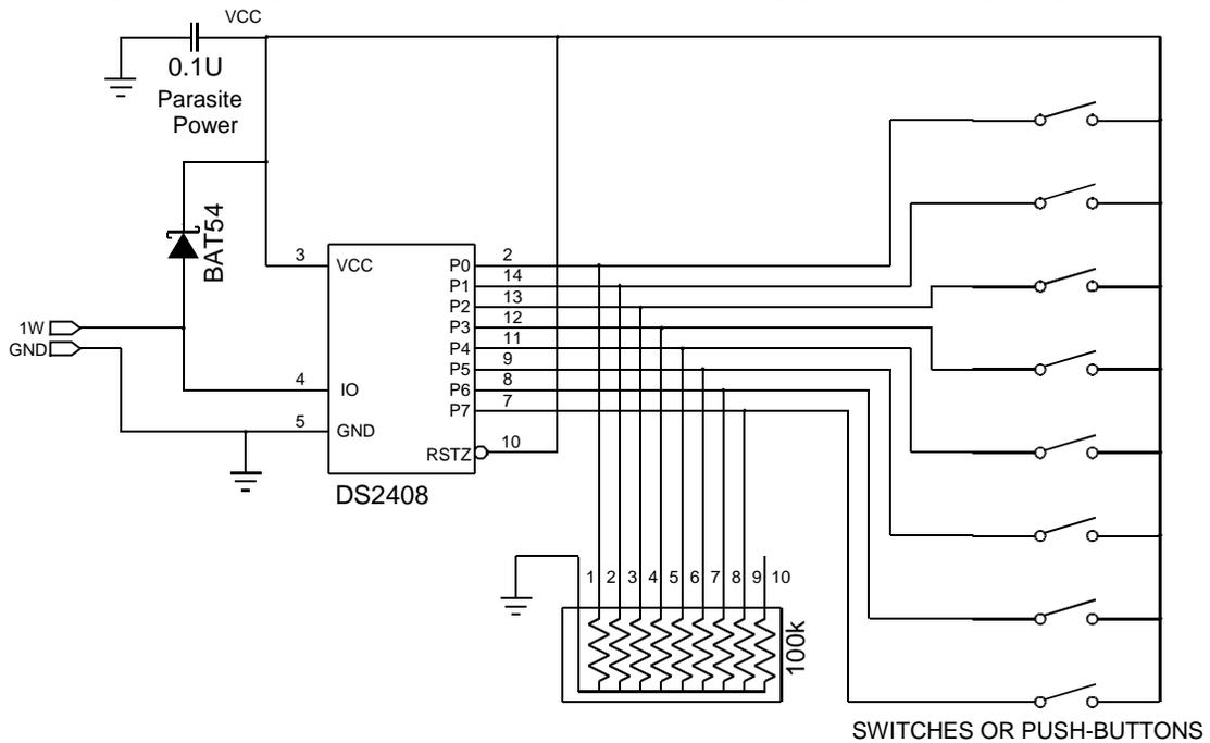
**Figure 22. DS2408 AS MULTIPURPOSE SENSOR/ACTUATOR**
