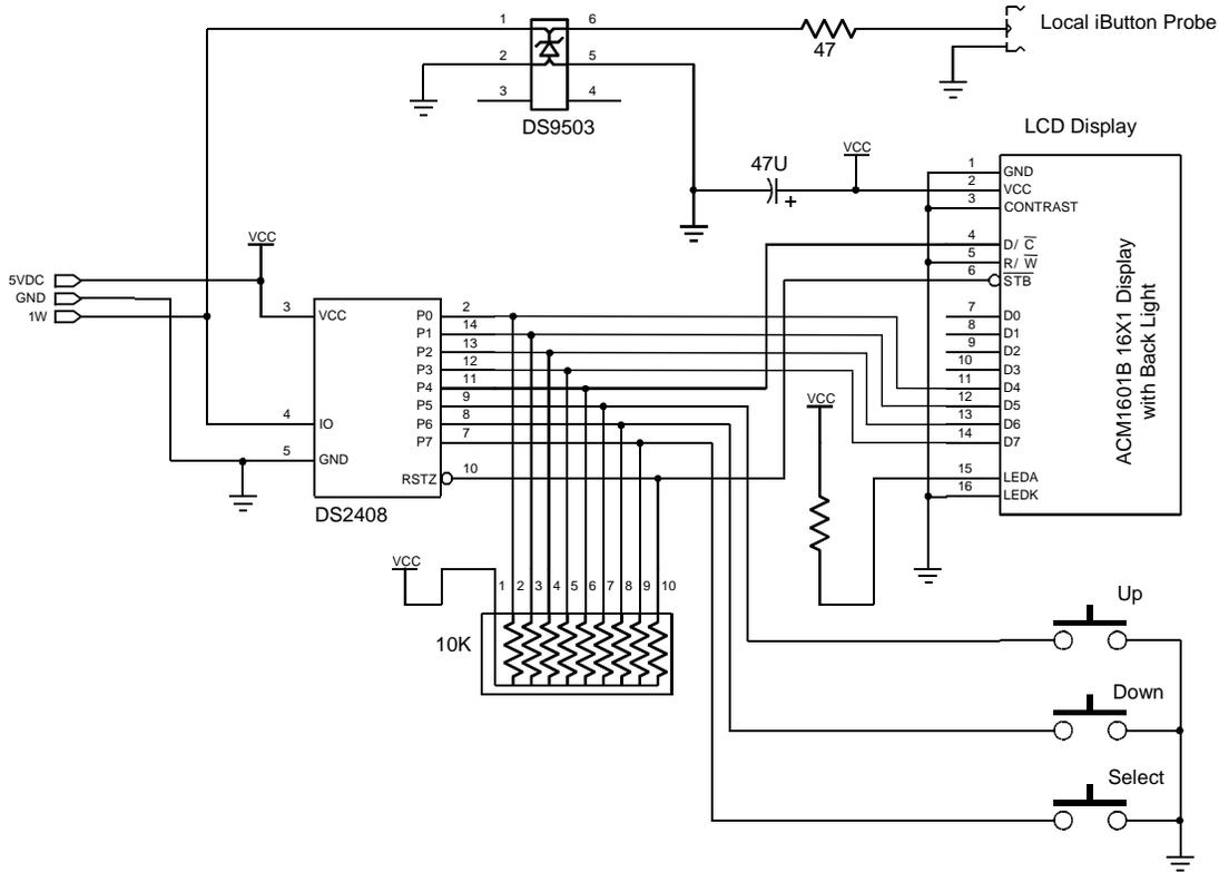
**Figure 19. DS2408 AS MICROCONTROLLER PORT EXPANDER**
