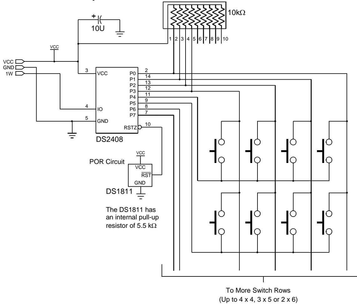
**Figure 21. DS2408 AS PARASITE-POWERED PUSH-BUTTON SENSOR**
