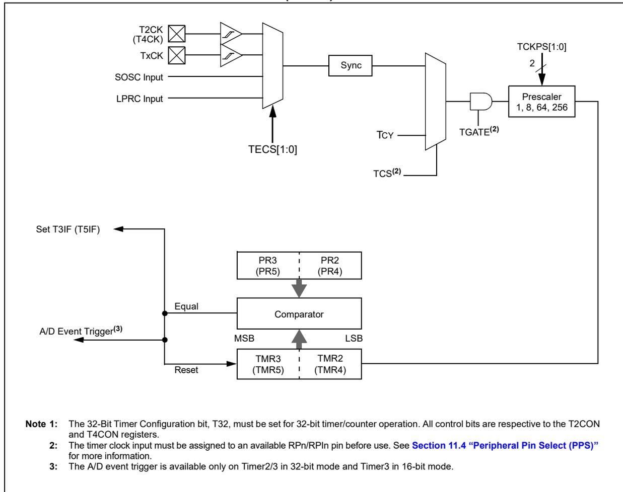
**FIGURE 13-2: TIMER2-TIMER5 (16-BIT) BLOCK DIAGRAM**
