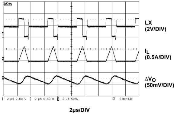
**FIGURE 12. PFM STEADY-STATE OPERATION WAVEFORM**
