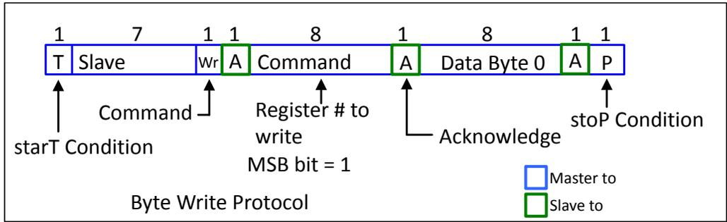
Figure 8.4. Byte Write Protocol
