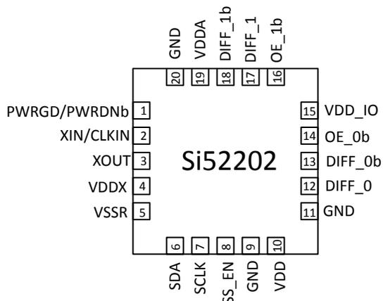
Figure 9.4. 20-pin QFN
