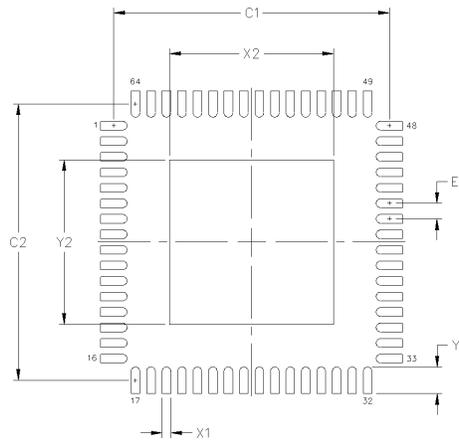
Figure 10.2. 64L 9 x 9 mm QFN Land Pattern
