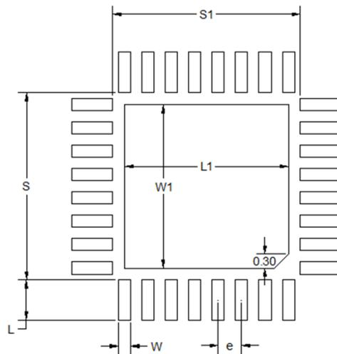
Figure 10.6. 32L 5 x 5 mm QFN Land Pattern
