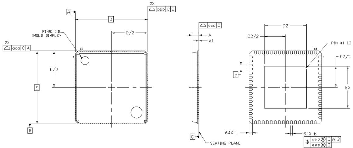
**Figure 10.1. 64L 9 x 9 mm QFN Package Diagram**
