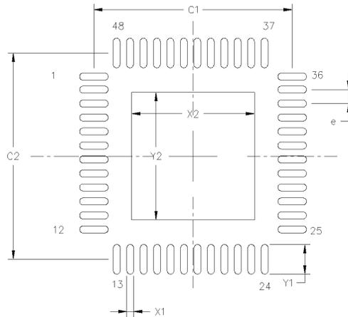
**Figure 10.4. 48L 6 x 6 mm QFN Land Pattern**
