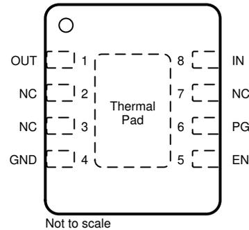
**Figure 5-4. DRB Package, 8-Pin Fixed VSON (Top View)**
