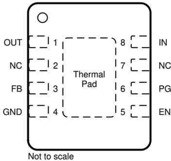
**Figure 5-3. DRB Package, 8-Pin Adjustable VSON (Top View)**
