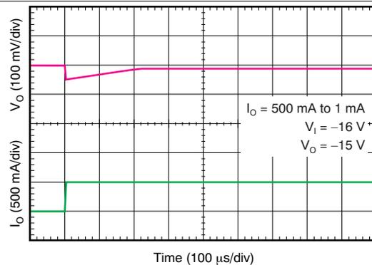
Figure 24. Load Transient
