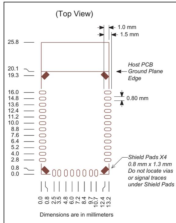
**FIGURE 2-2: RN41N RECOMMENDED PCB FOOTPRINT**
