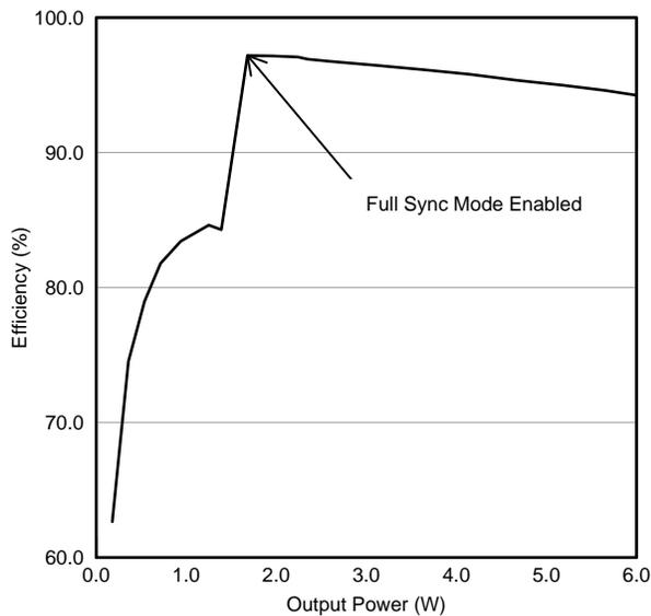
**Figure 4. Rectifier Efficiency**
