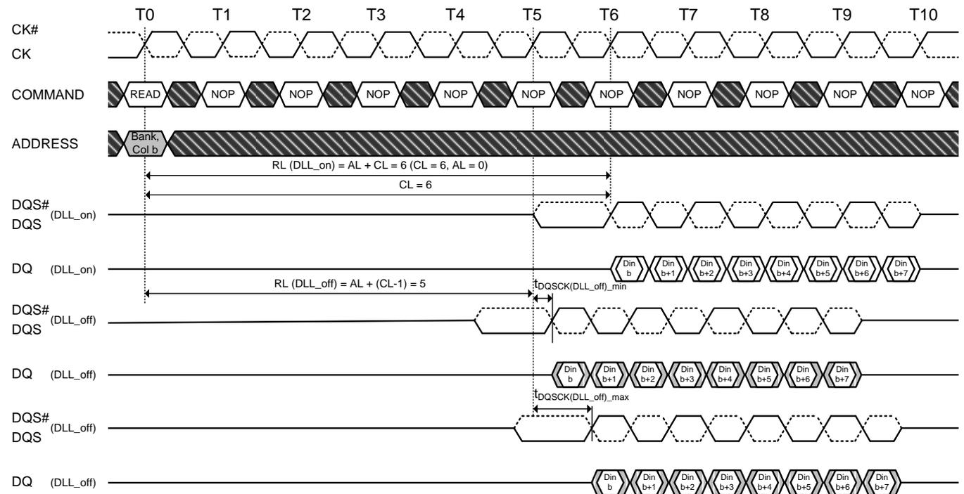
**NOTE 1.** The tDQSCK is used here for DQS, DQS# and DQ to have a simplified diagram; the DLL\_off shift will affect both timings in the same way and the skew between all DQ and DQS, DQS# signals will still be tDQSQ.
